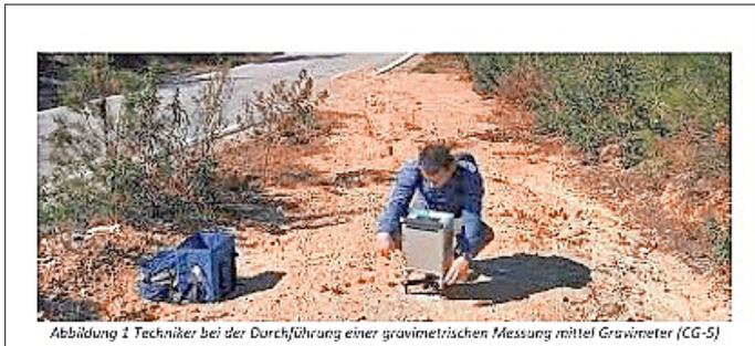
Abbildung 2 Techniker bei der Durchführung einer gravimetrischen Messung mittel Gravimeter (CG-5)
